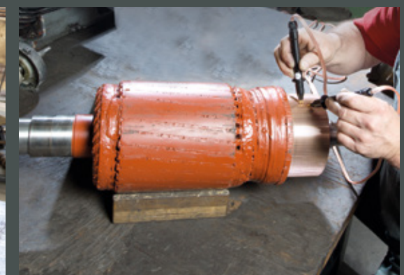
Prüfung von Gleichstromankern
