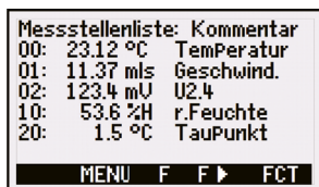
Messstellenliste zur vollständigen Übersicht über alle angeschlossenen Fühler
