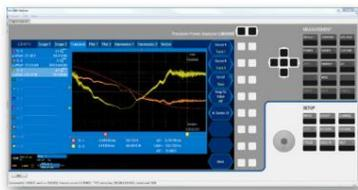
Die LMG Remote PC-Software ermöglicht die einfache Fernsteuerung des LMG600 von einem Windows-PC aus. Da diese Software das Messgerät selbst bis ins letzte Detail nachbildet, lässt sich das LMG600 wie gewohnt auch vom PC aus bedienen – kein Umdenken, keine Einarbeitungszeit.
