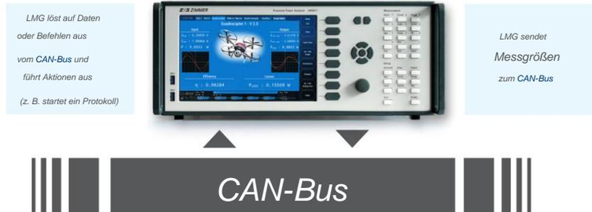
Mit der Softwareversion kann das LMG600 auch über den CAN-Bus gesendete Informationen lesen und abhängig von deren Inhalt eine Reihe vordefinierter Aktionen ausführen. Das heißt, die CAN-Bus-Schnittstelle des Leistungsanalysators ist bidirektional geworden und verwandelt ihn von einem rein passiven Sensor in ein fernsteuerbares Analysetool.
