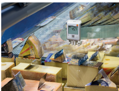
Kühltruhen-Überwachung im Supermarkt (testo Saveris 2-T1)
