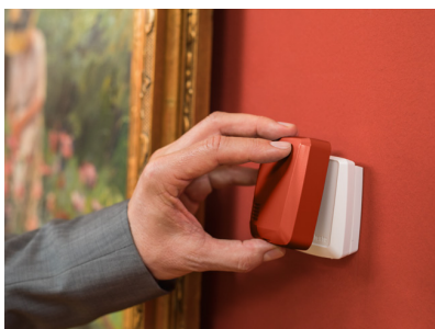
Visuell in Umgebung integrierte Temperaturmessung (testo 160 THL, THE, E mit Dekocover)
