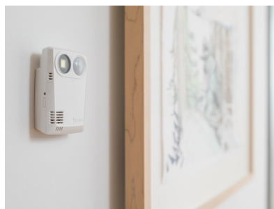
Museumsobjekte durch Licht- und Klimamessungen schützen (testo 160)
