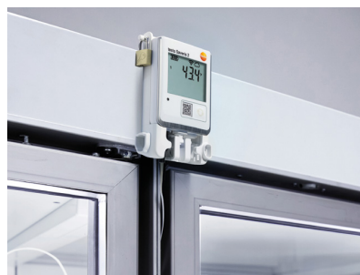
Ultratiefkühlschrank-Überwachung im Labor (testo Saveris 2-T3 mit Temperaturfühler)
