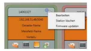
Über die Funktion der "Setup allgemein" der Stationskachel kann ein Firmwareupdate für das Messgerät multimess D9-PQ durchgeführt werden.
