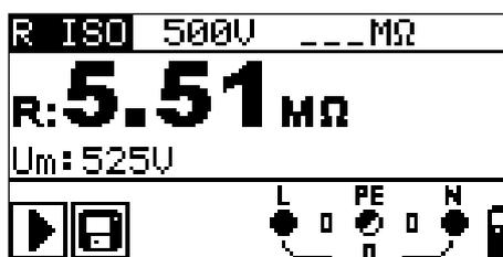
Abbildung 5.7: Beispiele für Ergebnisse der Isolationswiderstandsmessung
