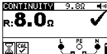
Abbildung 5.12: Beispiele für Ergebnisse der kontinuierlichen Widerstandsmessung
