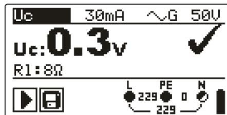
Abbildung 5.18: Beispiel für die Ergebnisse einer Berührungsspannungsmessung
