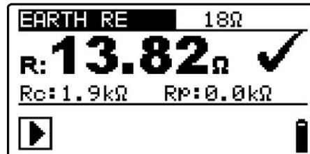
Abbildung 5.35: Beispiele für Ergebnisse der Erdungswiderstandsmessung
