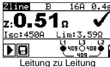
Abbildung 5.29: Beispiele für Ergebnisse der Leitungsimpedanz-Messung
