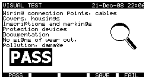
Beispiel für Messergebnisse der Sichtprüfung
