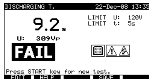
Beispiele für Messergebnisse der Entladezeit
