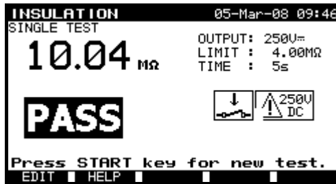
Beispiele von Ergebnissen der Isolationswiderstandsmessung
