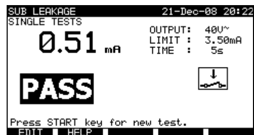
Beispiele von Ergebnissen der Messung des Ersatzableitstroms
