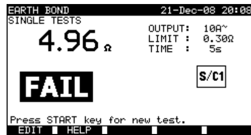
Beispiele von Ergebnissen der Messung des Schutzleiterwiderstands
