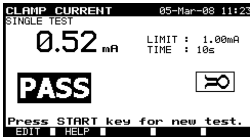
Beispiel eines Ergebnisses der Messung des Zangenstroms
