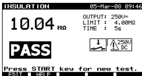
Beispiele von Ergebnissen der Isolationswiderstandsmessung
