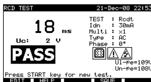
Beispiel für Messergebnisse der RCD-Auslösezeit
