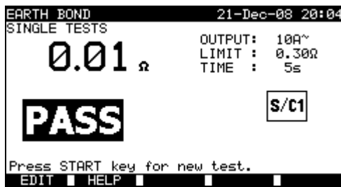
Beispiele von Ergebnissen der Messung des Schutzleiterwiderstands
