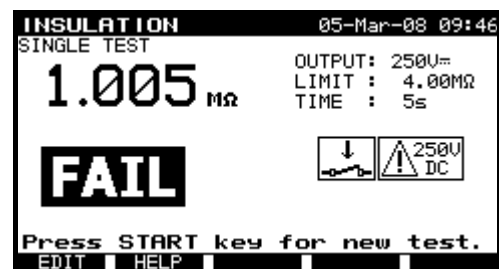
Beispiele von Ergebnissen der Messung des Isolationswiderstands
