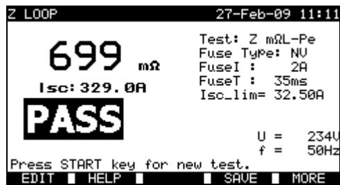
Beispiel von Ergebnissen der Fehlerschleifenmessung Z mΩ-Pe
