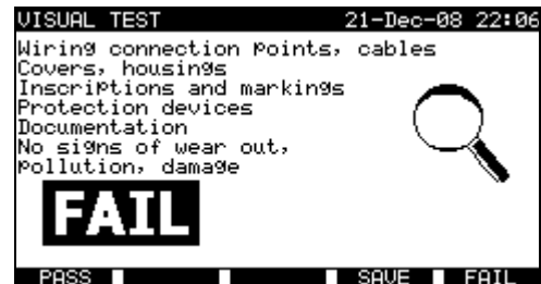
Beispiel für Messergebnisse der Sichtprüfung
