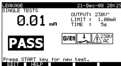
Beispiele von Ergebnissen der Messung des Differenzstroms
