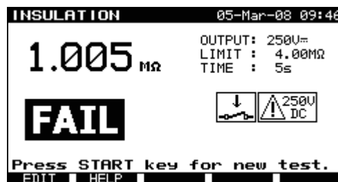
Beispiele von Ergebnissen der Isolationswiderstandsmessung
