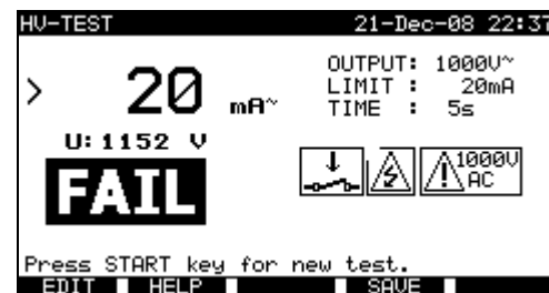
Beispiele für Ergebnisse der Hochspannungsprüfung
