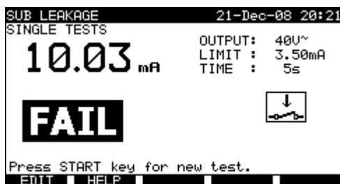
Beispiele von Ergebnissen der Messung des Ersatzableitstroms
