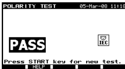
Beispiele von Ergebnissen der Polaritätsprüfung
