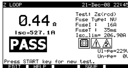
Beispiele von Ergebnissen der Messung der Fehlerschleifenimpedanz
