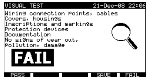
Beispiele für Messergebnisse der Sichtprüfung
