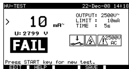
Beispiele für Ergebnisse der Hochspannungsprüfung
