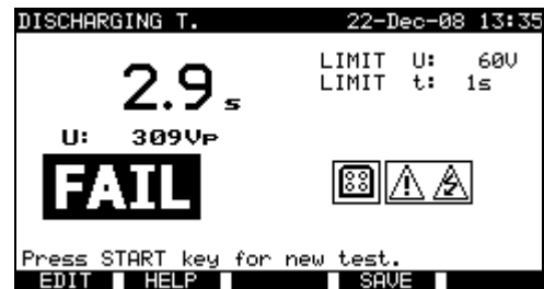
Beispiele für Messergebnisse der Entladezeit
