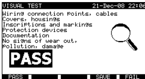
Beispiele für Messergebnisse der Sichtprüfung
