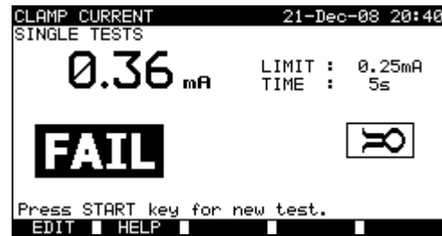
Beispiel eines Ergebnisses der Messung des Zangenstroms
