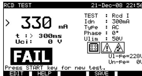
Beispiele für Messergebnisse des RCD-Auslösestroms
