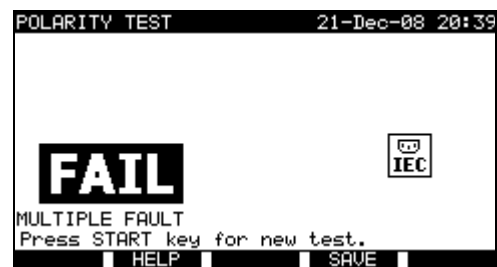
Beispiele von Ergebnissen der Polaritätsprüfung
