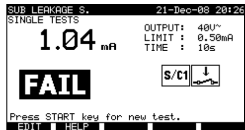
Beispiele von Ergebnissen der Messung des Ersatzableitstroms
