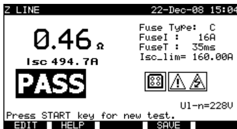
Beispiele der Ergebnisse der Messung der Leitungsimpedanz
