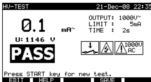
Beispiele für Ergebnisse der Hochspannungsprüfung
