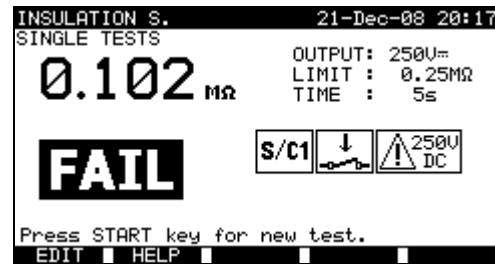
Beispiel von Ergebnissen der Messung des Isolationswiderstands-S
