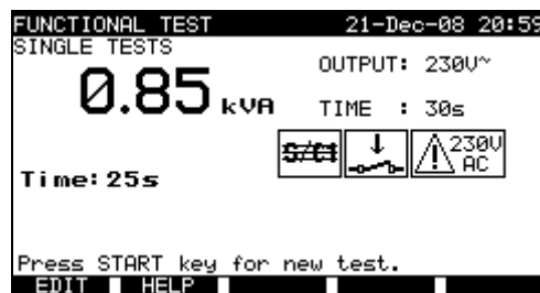
Beispiel eines Ergebnisses der Messung des Scheinstroms
