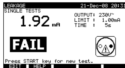
Beispiele von Ergebnissen der Messung des Differenzstroms
