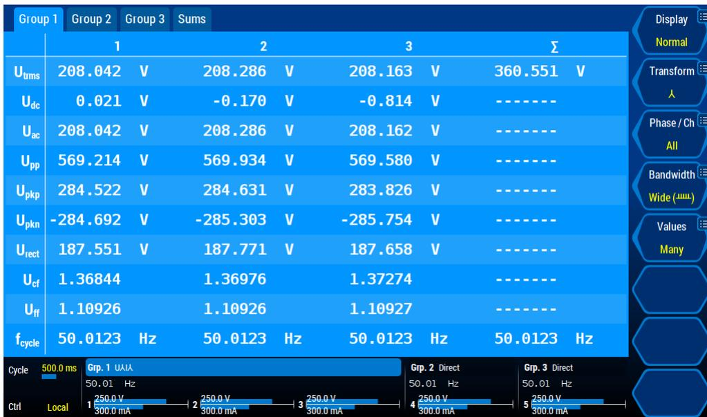
Abbildung 6.12: Standard Menü mit vielen Werten. Das [VOLTAGE] Menü zeigt übliche Spannungswerte aller drei Phasen in Dreiecks-Schaltung mit großer Bandbreite und zusätzlich die Summenwerte der Gruppe 1.
