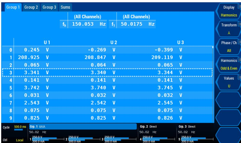
Abbildung 6.13: Standard-Menü mit Harmonischen Werten. Das [DEFAULT] Menü zeigt in dieser Einstellung die Spannungsharmonischen aller Phasen der Gruppe 1.
