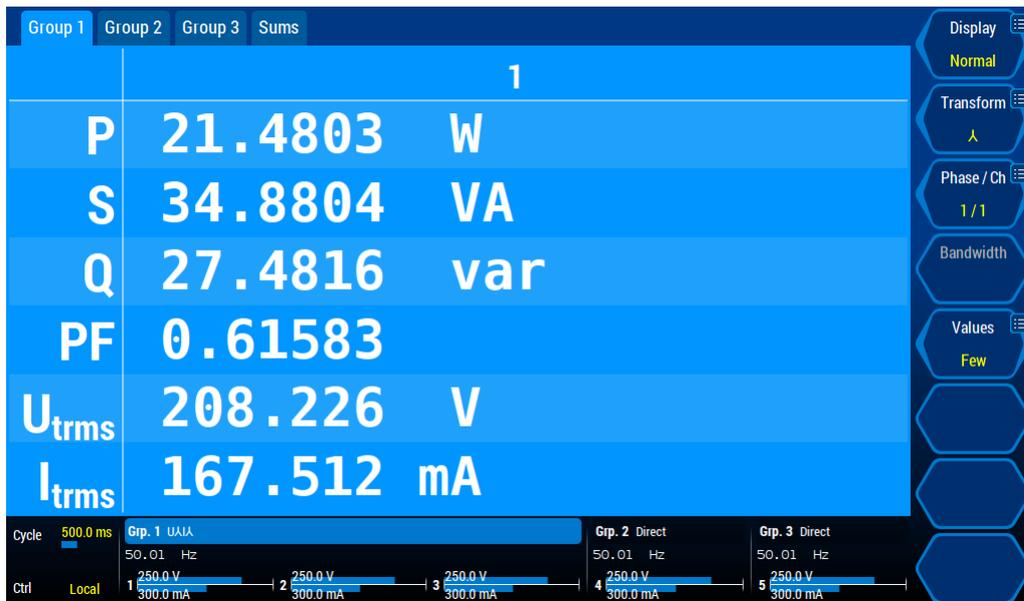
Abbildung 6.10: Standard Menü mit Werten der ersten Gruppe. Man sieht zyklusbasierte Werte im Default Menü. Die Werte sind schmalbandig von der ersten Phase der Sternschaltung der ersten Gruppe.
