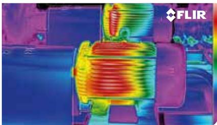
Kontinuierliche Überwachung eines Motors.
