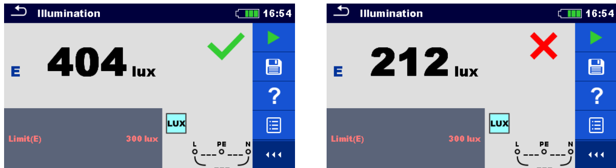
Abbildung 7.79: Beispiele für Ergebnisse Beleuchtungsstärkemessung
