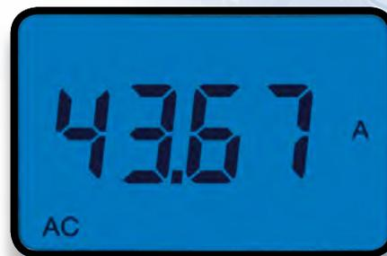
2. Drücken Sie die Funktionstaste **True *InRush***. Die Messzange zeigt nun die Auslöseschwelle für die InRush-Erkennung an und geht in den Überwachungsmodus.
